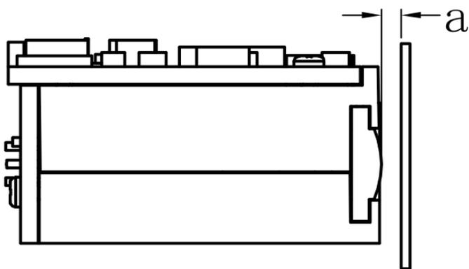
若窗口需倾斜设计，距离的要求与平行安装相同，倾斜角度应保证没有可反射入镜头的各种光束，以保证识读性能。
