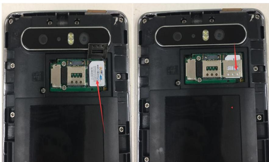
图 2.4-2 安装 SIM 卡
